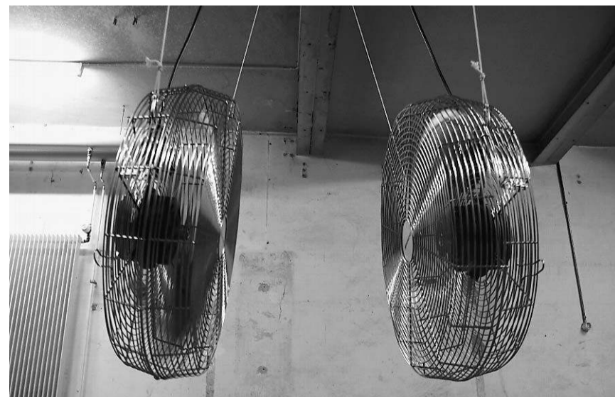
Ausprobiert im Atelier: Laufende Ventilatoren drücken sich weg.
